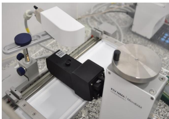
Rys. A. Stanowisko badawcze: waga Langmuir'a-Wilhelmy'ego i mikroskop kąta Brewster'a
